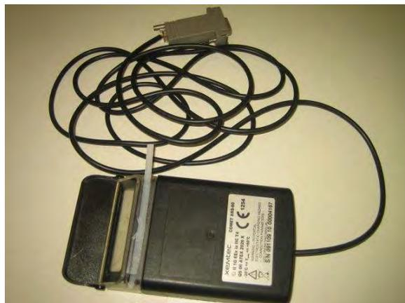
Figure 17 : exemple de lecteur d'index de compteur optique
