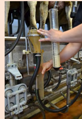
Figure 2. Le tru-test est l'outil utilisé pour collecter l'échantillon de lait du contrôle laitier. Il permet également de mesurer, pour chaque vache, le poids de lait collecté lors de la traite
