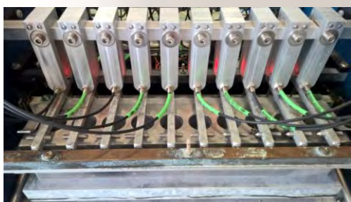
Figure 2 : Le Formoptic permet d' valuer l'aptitude   la coagulation du lait (10  chantillons   la fois)
