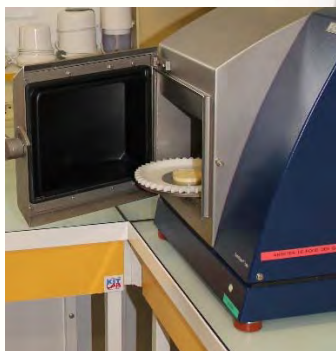
Le FOODScan analyse la matière grasse et protéique, l'humidité, l'extrait sec total, le sel des fromages à 20h
